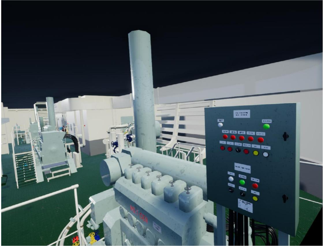
Image8-49 机舱发电机控制箱
