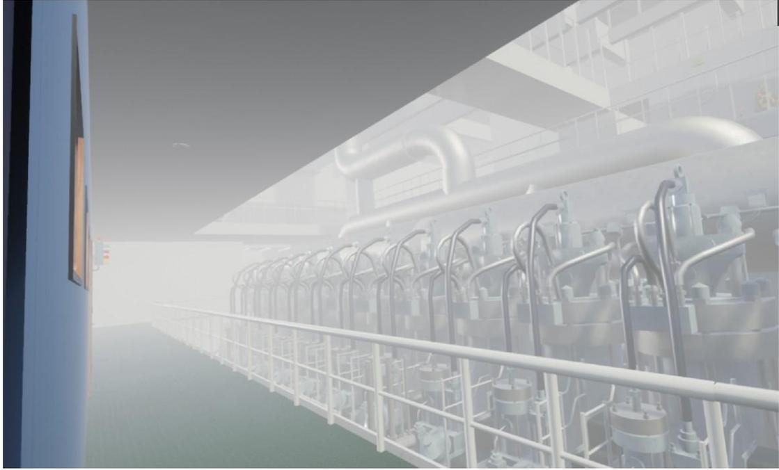
image 8-15 机舱释放大型二氧化碳灭火效果
